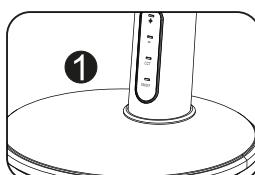
Vložte sloupek lampy do podstavce a ujistěte se o správné pozici usazení.
