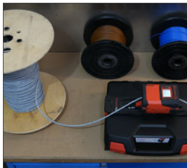
Montážní deska a systémový kufr RM35 při kompletaci kabelů
