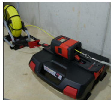
RM35 s montážní deskou , sys- témovým kufr a protahova- cím perem Ø 4,5 mm
