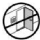
Termostat vždy instalujte nejméně do vzdálenosti 50 cm od oken a dveří.
